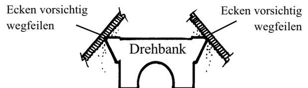
Abbildung 1: Abfeilen der Ecken des Drehbankprismas, um den Sitz des Reitstockerhöhungsblockes zu verbessern
