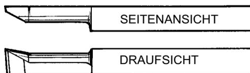
Abbildung 13: typischer Ausdrehstahl
